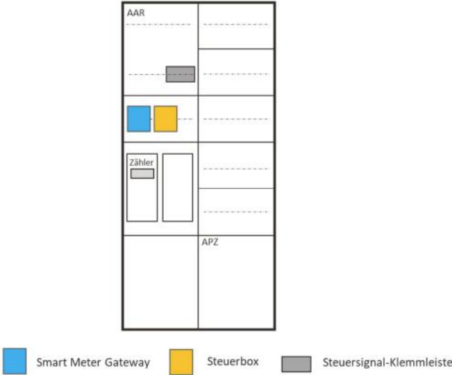
Abbildung 4: Beispiel für Anordnung bei analoger Steuerung (Quelle: bdew Anwendungshilfe)
