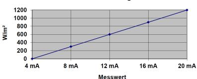
Messwert momentan eingespeiste Wirkleistung, Klemme 12/13 der Übergabeklemmleiste Es soll je nach der momentanen Wirkleistung der folgende Strom eingeprägt werden:
